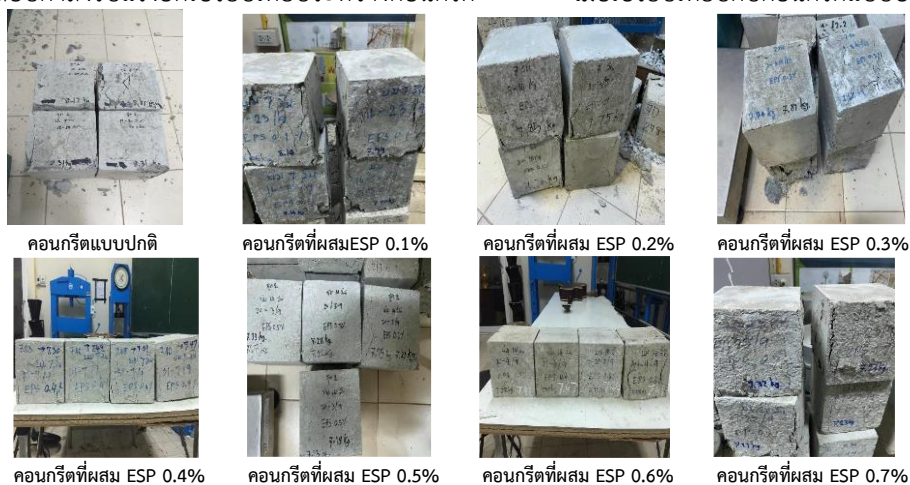
ภาพที่ 4 การเปรียบเทียบความเสียหายของตัวอย่างคอนกรีตแบบปกติกับคอนกรีตที่ผสมอีพีสโม่
