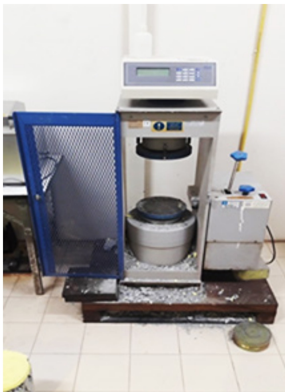
ภาพ 5 เครื่องทดสอบ Universal Testing Machine--UTM
