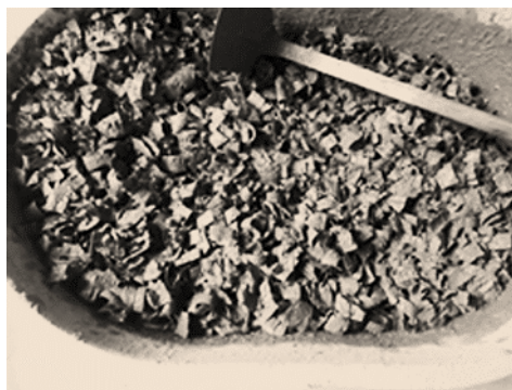
ภาพ 6 คอนกรีตที่มีส่วนผสมของพลาสติกโดยทดแทนมวลรวมหยาบที่มากเกินไป
